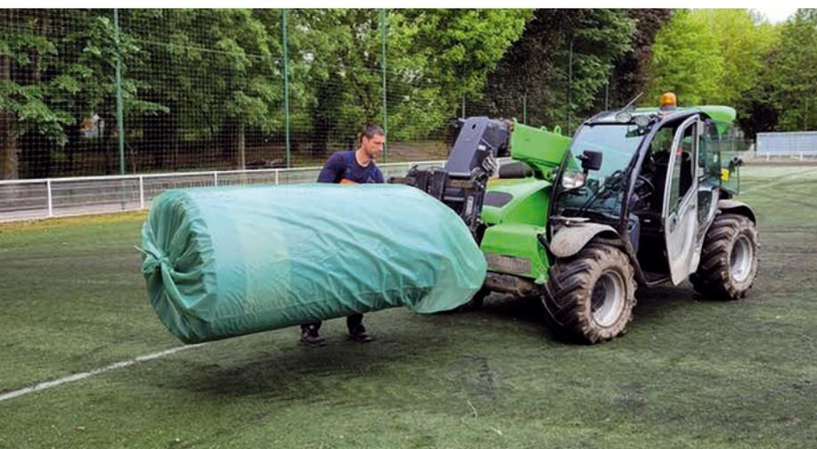
Re-Match a introduit l'utilisation des sacs en plastique recyclé pour éviter la dispersion des matériaux de remplissage et des microplastiques pendant le chargement, le transport ou le déchargement.
